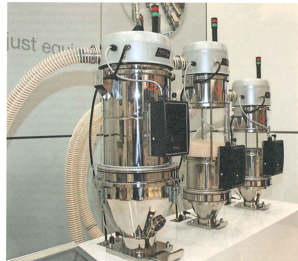
Das neue MWS-Modul (Material Weighing System) zur präzisen, maschinenbezogenen Durchsatzzerfassung ist als Flanschring nachrüstbar zwischen Trichter und Abscheider Foto: K-ZEITUNG
