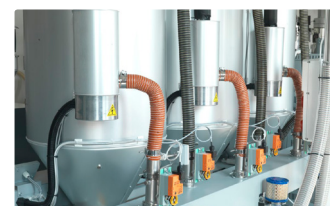
Valvola modulante per la gestione della portata d'aria.
